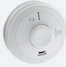
Lämpöilmaisin EI3014 • Hälytysraja: 58° +/- 4° C • 10 vuoden akku • EN5446-2:2003 • Sähkönumero: 71 397 03
